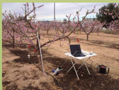
Figura 2. A: Esquema de la disposición del minirrizotrófono. B: Equipo completo para la medida de la dinámica de raíces en campo.
