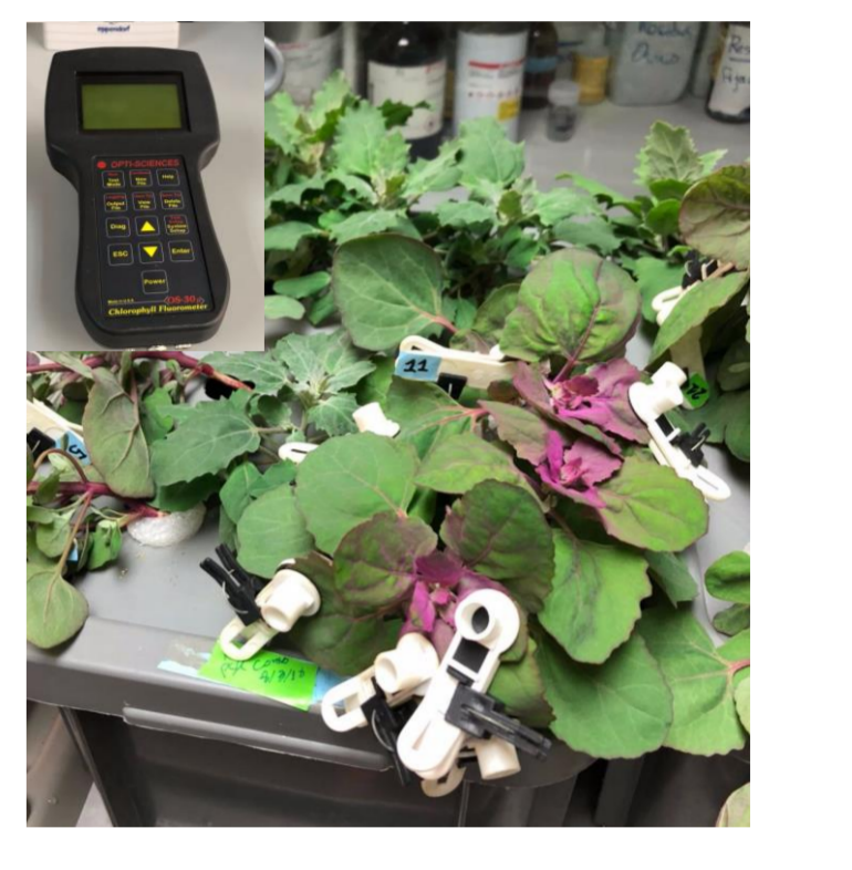
Figura 2. Imagen de fluorómetro portátil OS-30 (ADC BioScientific) en Pasankalla para la determinación de F_v/F_m .
